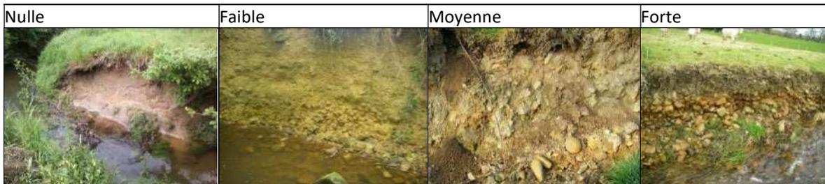
L'érodabilité est appréciée au regard de la nature des matériaux observés dans les berges (argiles, sables, graviers, etc.) et de leurs proportions. Elle est déterminée à la séquence de lit mineur, ce qui permet le calcul d'une valeur moyenne au niveau du segment.
